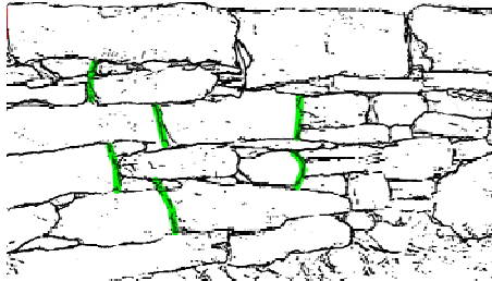
Abbildung 10: Guter Mauerverband, unterbrochene Vertikalfugen
